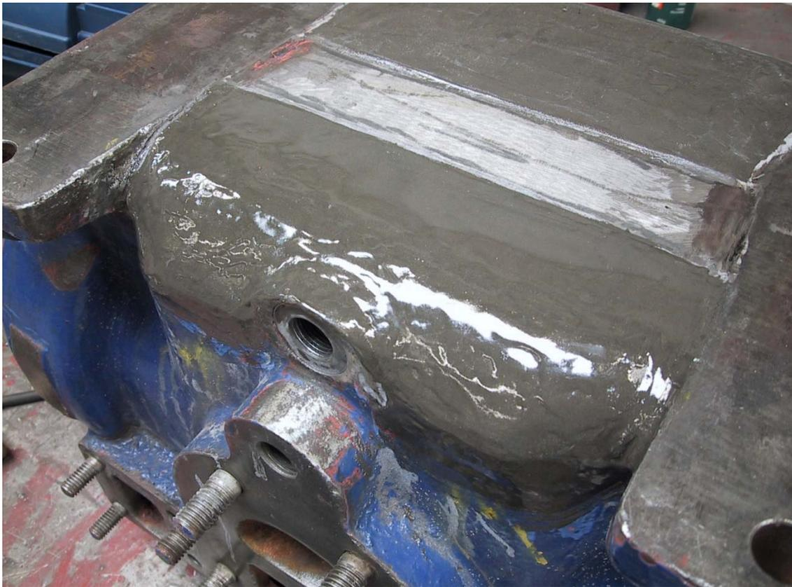
Ein gerissenes Pumpengehäuse wurde mit Hilfe des PolymerMetalls MM-metall SS-StahlKeramik instand gesetzt.
