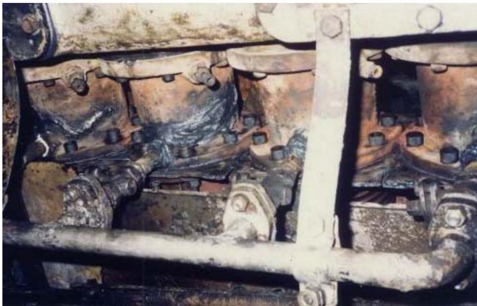
Instandsetzung eines Turboladers mit MM-metall SS-StahlKeramik. Heute empfiehlt MultiMetal bei einer Instandsetzung dieser Art das neue Produkt VP 10-500.
