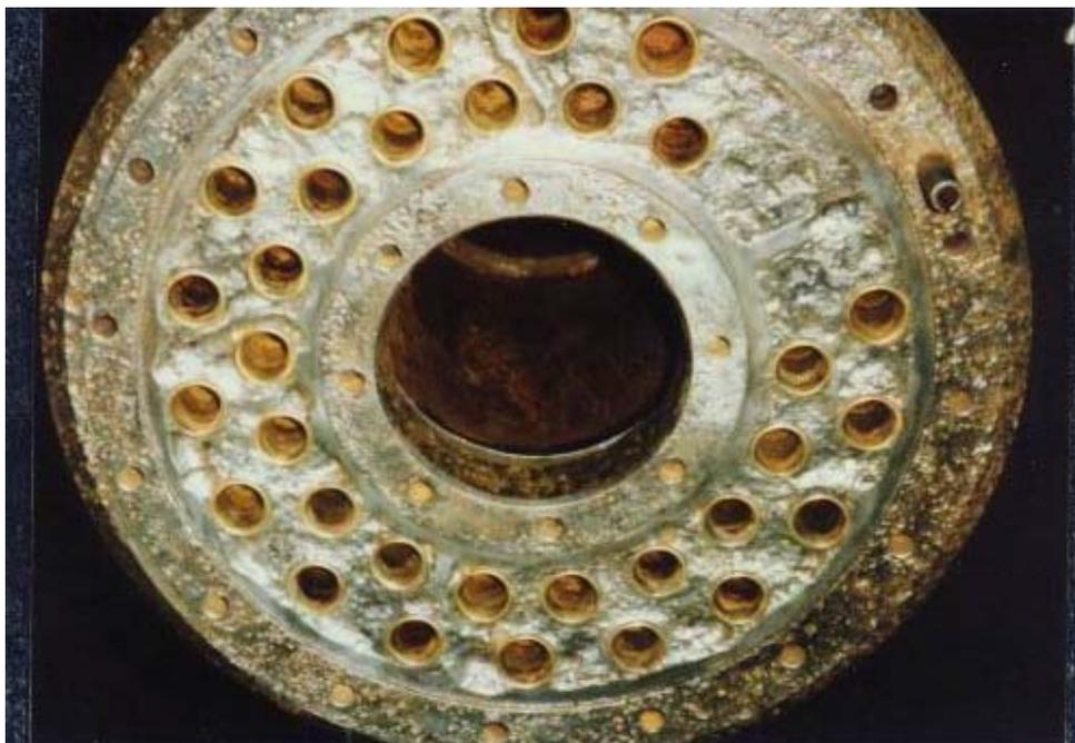
Reparatur eines Russbläserkompressors durch Beschichten des Nachkühlers mit Ceramium in einem Heizkraftwerk. Die Beschichtung wurde in zwei Schritten durchgeführt: eine erste Beschichtung mit Ceramium, pastös, dann folgte eine zweite Schicht Ceramium, flüssig.
