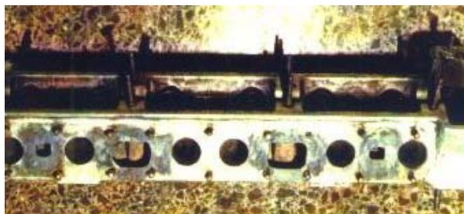
Der Zylinderkopf eines PKW-Motors, dessen Wasserkanäle verrottet waren, wurde mit MM-metal SS-StahlKeramik und Härter gelb instand gesetzt.
