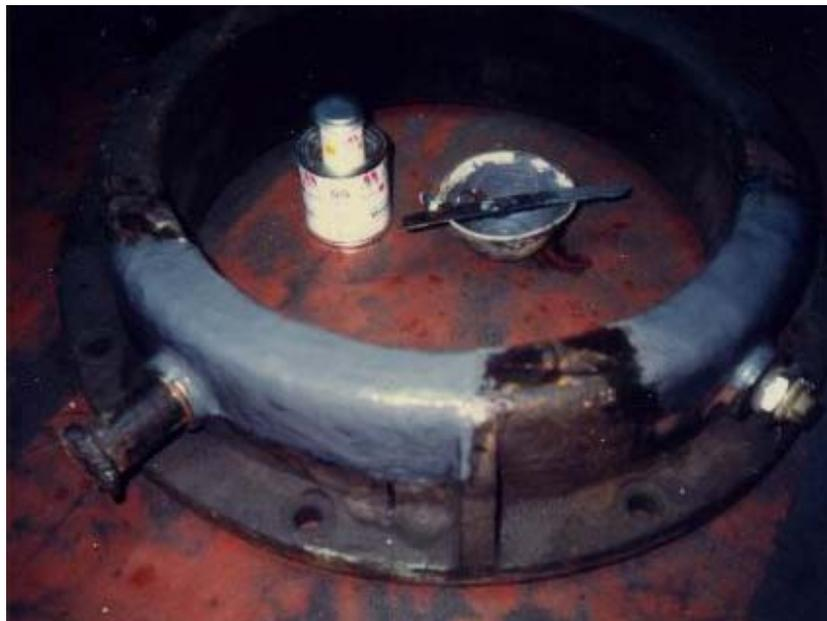
Korrosionsschäden an einer Bremstrommel verursacht durch Bremsstaub wurden mit MM-metal SS-StahlKeramik und Härter gelb instand gesetzt.
